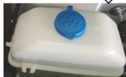
Serbatoio del liquido lavacrystalli
